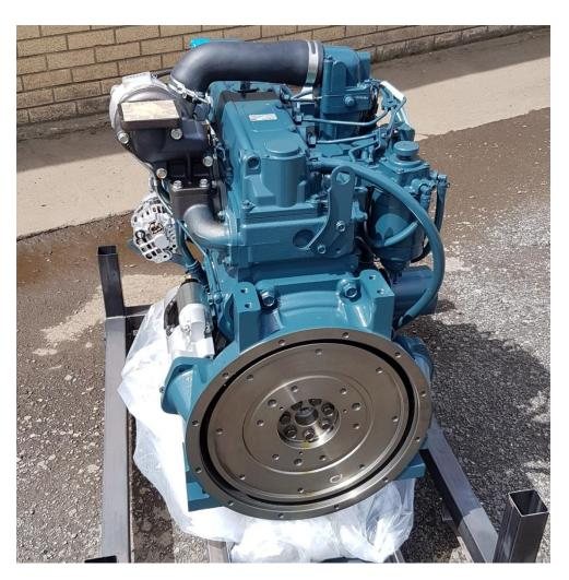
**Tipo:** inyección directa 4 cilindros diésel
